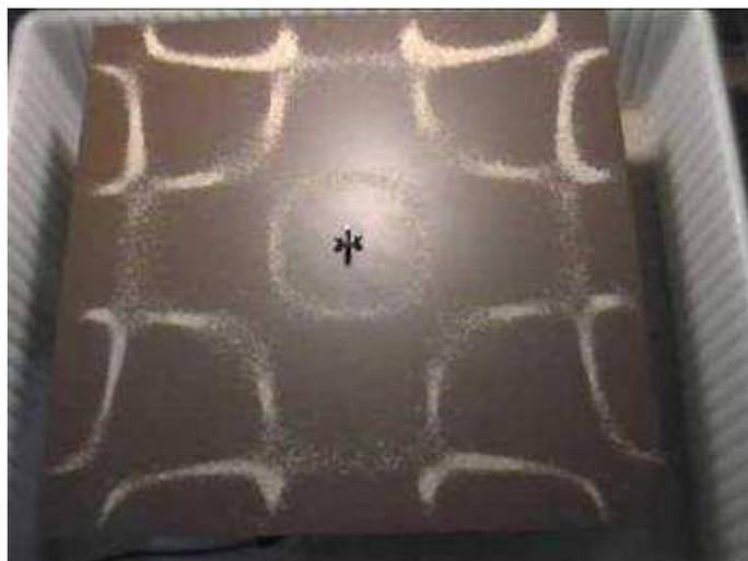
Figura 6. Desenho em tonoscópio formado por onda sonora instrumental. <sup>24</sup>
