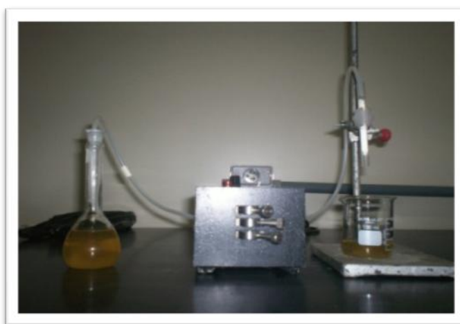
Figura 5: Passagem do chá de camomila alemã pela coluna com Porapak Q.
