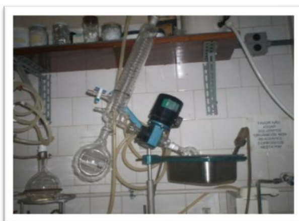
Figura 7: Processo de concentração do extrato em acetona da camomila alemã através de um sistema de rota-evaporação a vácuo.
