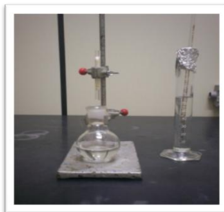
Figura 6: Extração dos compostos voláteis da coluna por eluição com acetona.
