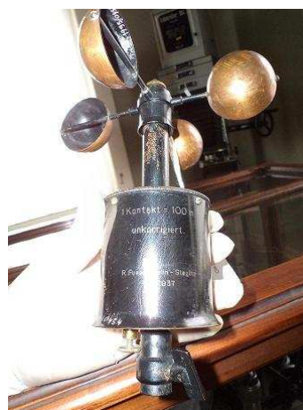
Figura 41 – Anemômetro 1995/0454 (Foto da autora, 2012).
