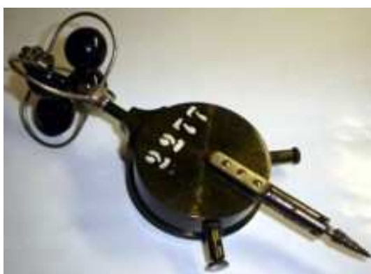
Figura 40 – Anemômetro 1995/0445 (Foto documentação museológica - MAST).
