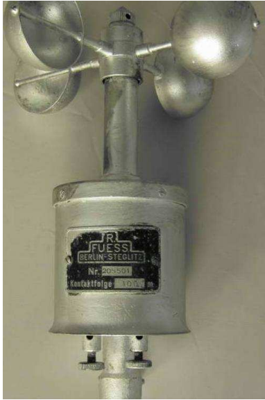
Figura 43 – Anemômetro semelhante ao instrumento musealizado apresentando o logotipo da Fuess (Fonte HISTORISCHE ANEMOMETER, 2009).
