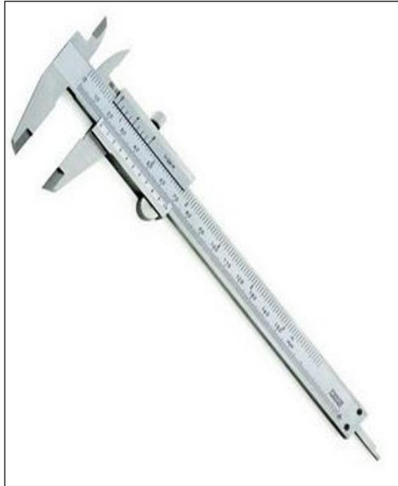
Figura 16 - Paquímetro
