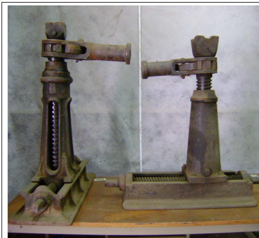
Figura 11. Macacos manuais de rosca. Usados para erguer locomotivas.
