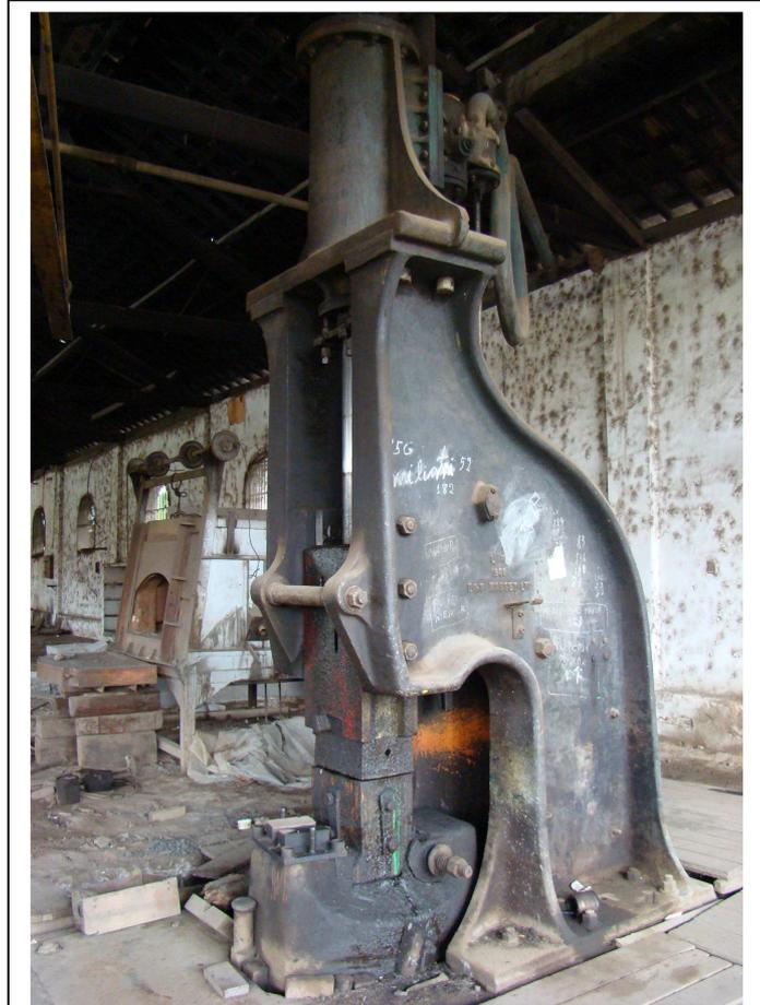
IMAGEM 15. Martetele a vapor. Seção de ferraria. Posteriormente adaptado para trabalhar com ar comprimido. Um dos poucos equipamentos que sobraram depois do sucateamento das máquinas da Oficina
