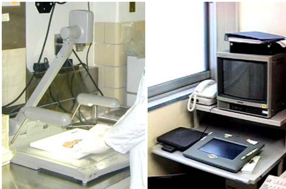
Figura IV.18. Exemplo de scanner de superfície e “Tablet” – Mesa digitalizadora. Fonte: The University of Pittsburgh Medical Center (U.S.A.)
