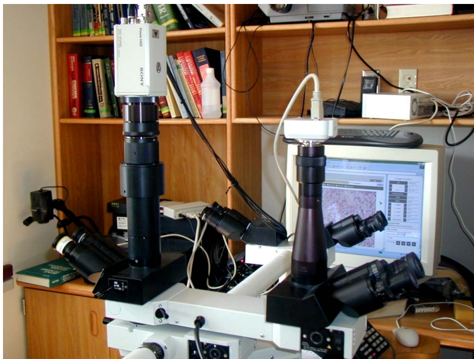
Figura IV.19. Exemplo de microscópio poliocular com telepatologia integrada. Fonte: The University of Pittsburgh Medical Center (U.S.A.)
