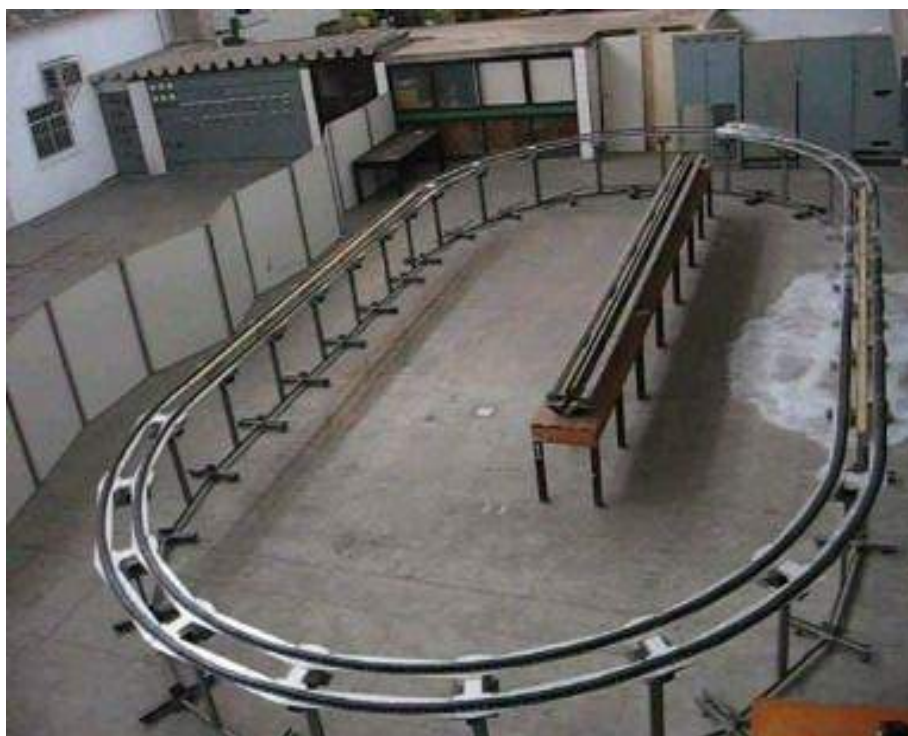
Acima, primeiro protótipo do Maglev- Cobra, cedido ao Espaço COPPE, abaixo, segunda fase de pesquisa com protótipo em linha circular, ainda no LASUP.
