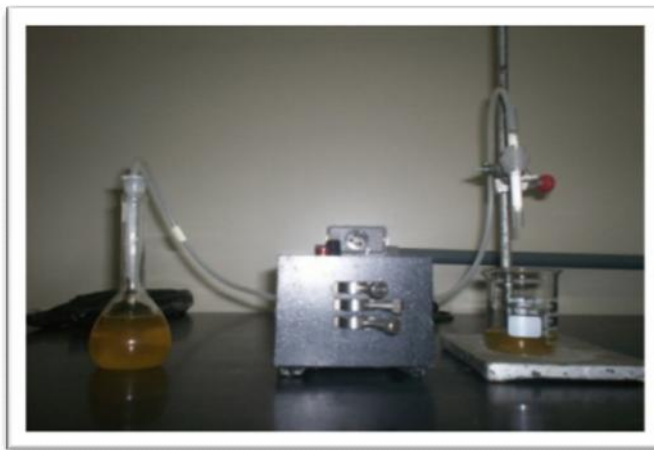
Figura 2: Passagem do chá de carqueja amarga pela Coluna com Porapak Q. Fonte: o autor.
