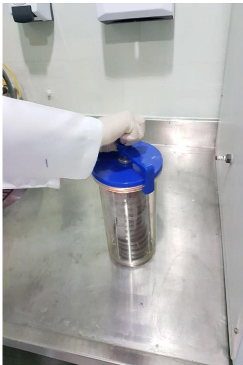
Figura 06 – Jarra de anaerobiose sendo fechada com chama acesa. Fonte: Autor, 2018
