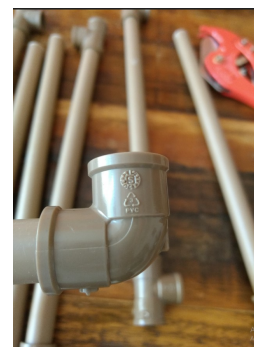
Foto 5 - joelho 90° de 20mm ou ½” fixado no lado direito
