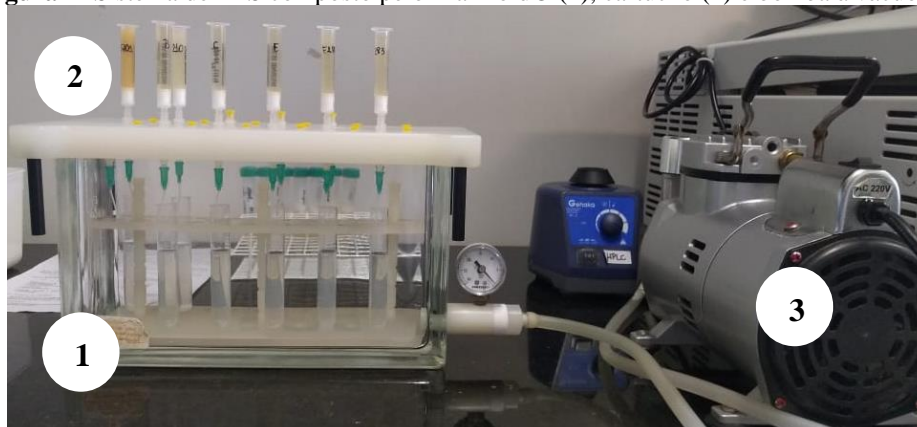
Figura 7- Sistema de EFS composto pelo Manifold® (1), cartucho (2) e bomba à vácuo (3)
