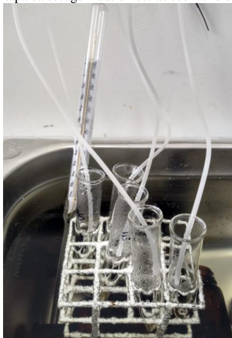
Figura 9- Etapa da secagem das amostras sob fluxo de nitrogênio.
