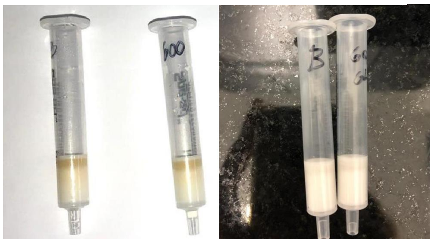
Figura 17 - Cartucho N+ eluído com Acetonitrila (esquerda) e cartucho N+ eluído com ácido acético 10% (direita)
