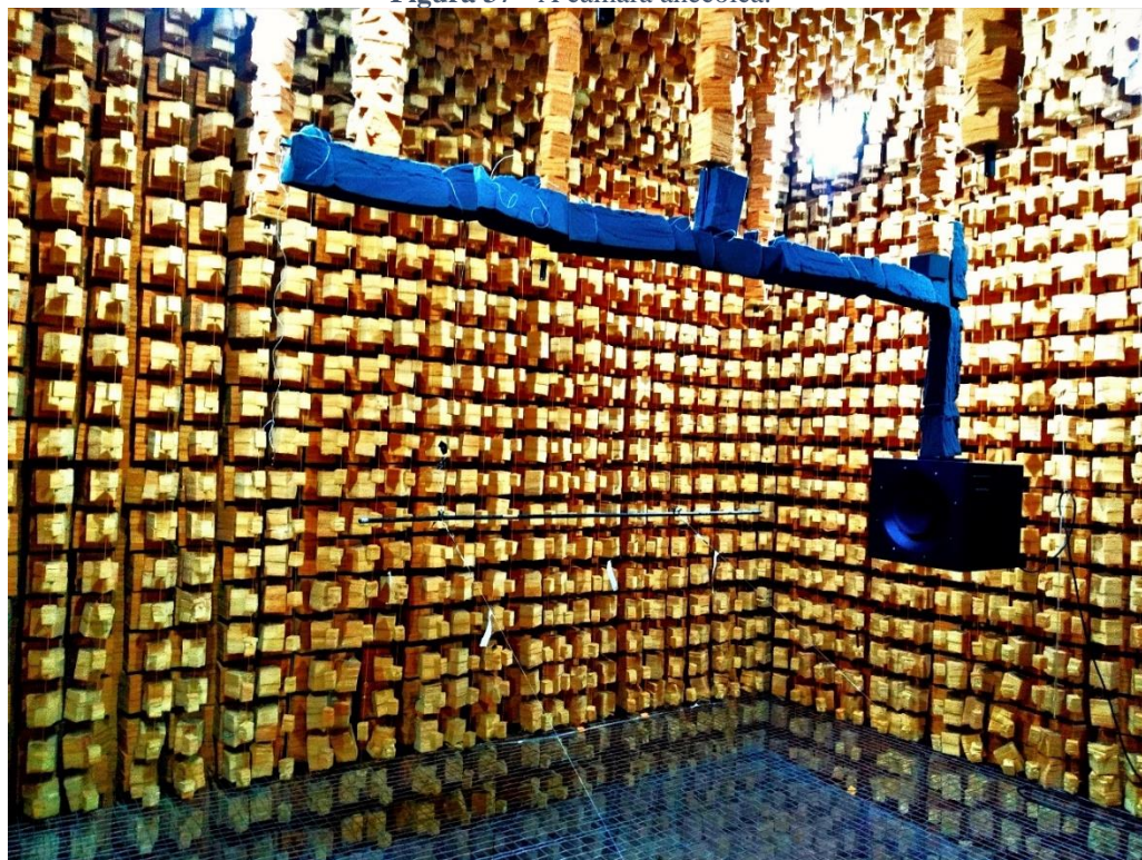
Figura 37 - A câmara anecoica.
