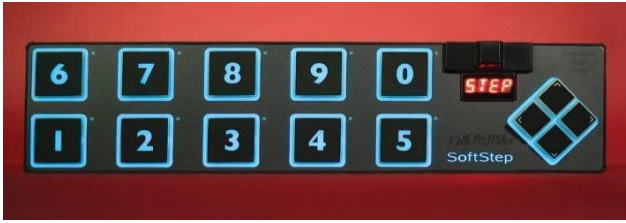
Figura 15: Softstep 1. Essa controladora é feita para ser acionada com os pés, o que possibilita tocar a guitarra e controlar o computador simultaneamente. São utilizados vários presets que permitem controlar diferentes parâmetros no software Ableton Live.
