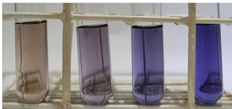
Imagem 6. Curva-padrão de reagente FRAP em ordem crescente de redução (da esquerda para a direita) Foto: Anna Carolina Alves
