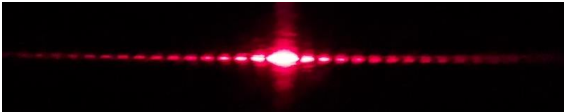
Figura 12 – Experimento Demonstrando o Padrão de Interferência Com Laser Ao Passar Por Uma Fenda
