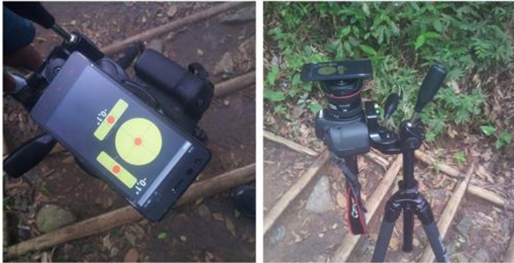
Figura 10 - Fotografia capturada com auxílio de nível de bolha e bússola
