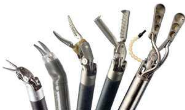
Figura 34– Exemplos de pinças específicas do robô da Vinci para cirurgias robóticas
