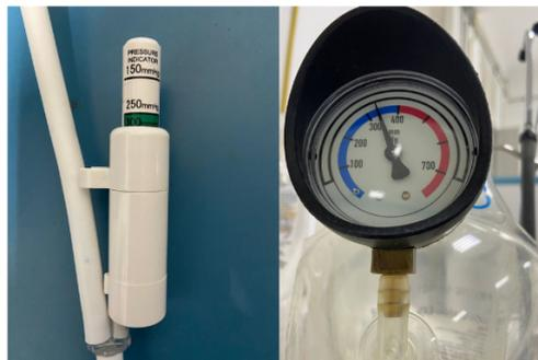
Figura 1-F: Modelos de indicação da pressão exercida pela bolsa pressórica.
