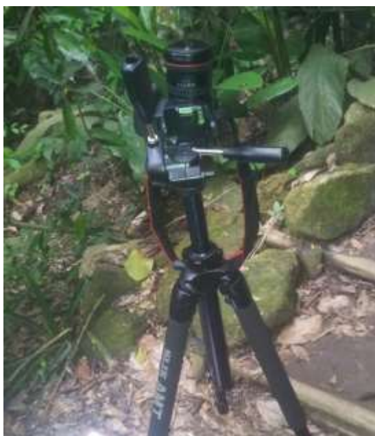
Figura 17 - Câmera CANON EOS 6D acoplada a uma lente Fisheye 8mm, com suporte de tripé, utilizada no registro das imagens hemisféricas. Monumento Natural dos Morros do Pão de Açúcar e da Urca, Rio de Janeiro, RJ.
