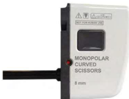
Figura 10: Em vermelho, indica-se que o instrumento está expirado. Indicador do Número máximo de utilizações.
