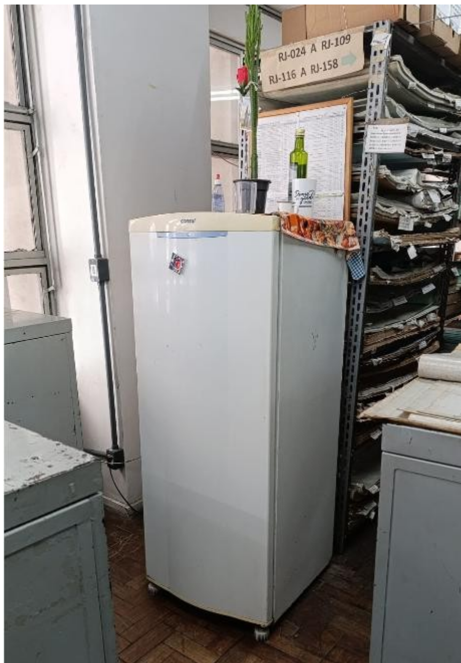
Figura 52 – Aparelhos eletrodomésticos utilizados dentro do ambiente de guarda documental podem causar incêndios, fungos e mofo. Pode ocorrer o superaquecimento nos documentos próximos ao fundo da geladeira. Além disso, restos de alimentos podem atrair insetos e roedores.
