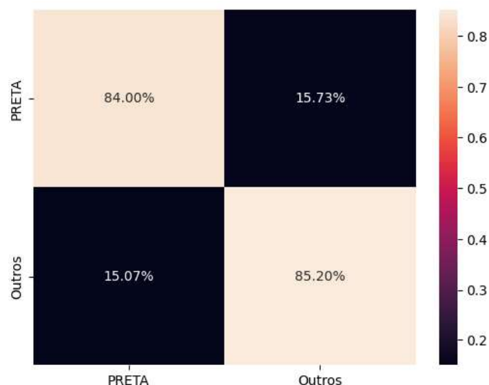
Figura 20: Matriz de confusão de classificação para o classificador binário OvR Pretas vs Outros, baseado em VGG-16 adaptado e treinado sobre o conjunto de dados Faces da Pindorama.
