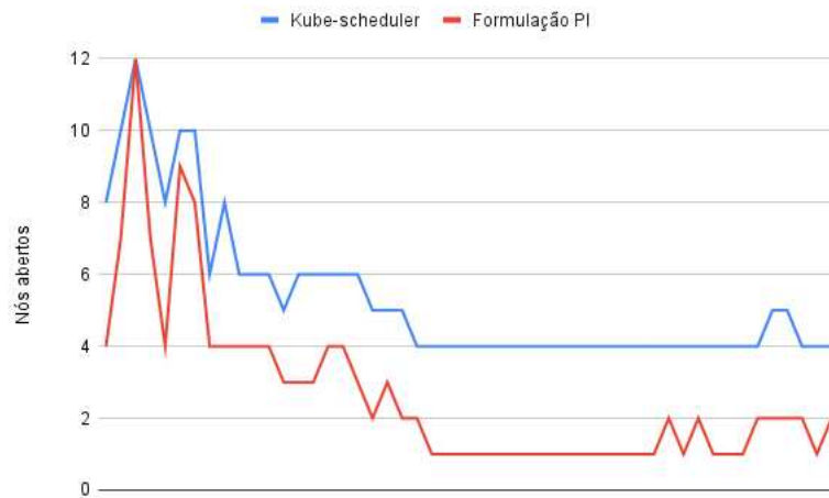
Figura 6.29: Comparativo entre a abertura de nós das soluções dos algoritmos padrão do Kube-scheduler e de formulação PI para determinada quantidade de nós no terceiro conjunto de estudos experimentais computacionais, iniciados com 5000 pods .
