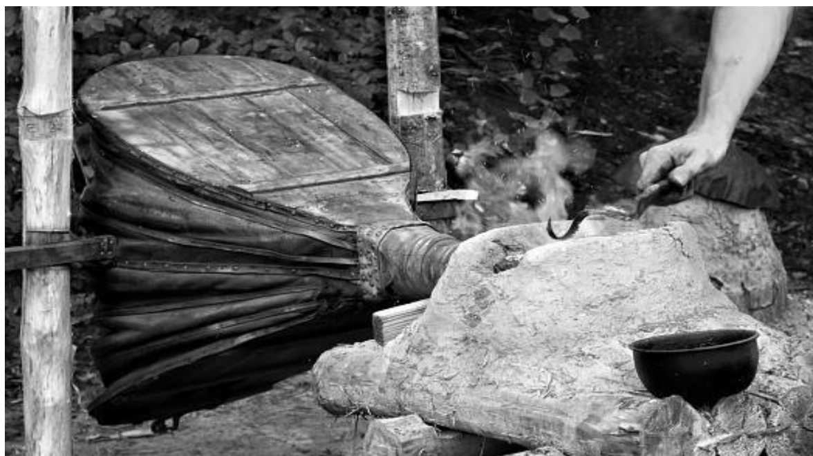
Figura 3 - Representação de um fole de ferreiro
